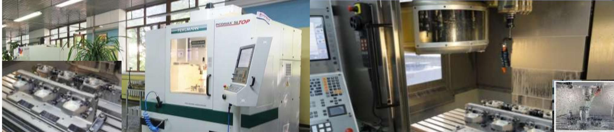
Изготовление деталей тел вращения на двухшпиндельных автоматах продольного точения с приводным инструментом
