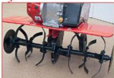
Редуктор культиватора — цепной, разборный, в стальном корпусе. На выходной вал редуктора возможна установка до трёх пар фрез и, если требуется, пары дисков для защиты растений
