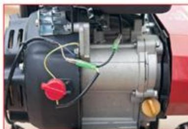
Жёлтая пробка маслозаливной горловины, пробка для слива масла и выключатель двигателя расположены спереди. Вторым, дублирующим, выключателем установлен на рукоятке управления
