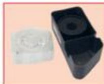
Поролоновый многоразовый воздушный фильтр устанавливается в масляную ванну (небольшое количество масла заливается в белый корпус). Крышка фильтра крепится на гайке-барашке
