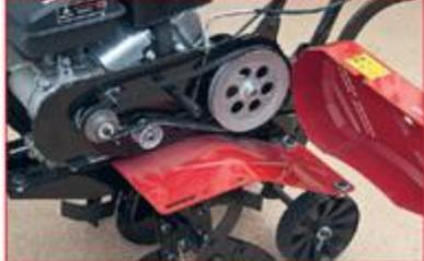
Ременное сцепление. Гайки крепления ролика и ведомого шкива с пластиковой вставкой — защитой от отворачивания в процессе работы. Между стальным тросом привода и рычагом прижимного ролика установлена пружина, рядом с ведущим шкивом находится стальной гаситель колебаний ремня
