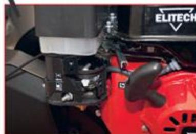
Рычажки топливного крана и управления воздушной заслонкой находятся на двигателе, рядом с пусковой рукояткой
