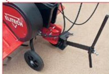
Культиватор оборудован парой задних опорных колёс, поднимающихся при работе, и сцепкой с закрепляющимся на ней сошником. Для установки сошника инструмент не нужен — он крепится на стальном пальце
