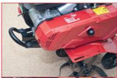
Кожух ременной передачи крепится единственным винтом. Для доступа к сцеплению достаточно вручную отвернуть винт и откинуть кожух. Стальной передний бампер может служить рукояткой для переноски
