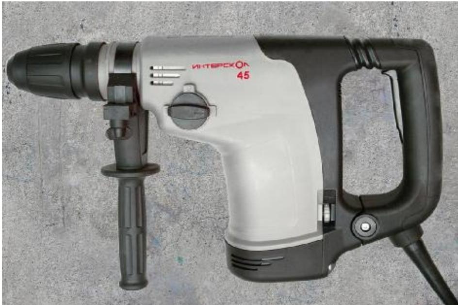
Модель «ИНТЕРСКОЛ» П-48/1300Э мощностью 1350 Вт и массой 7,5 кг отличается более высокой энергией единичного удара, регулируемой в диапазоне 1–12 Дж, и предназначена для работы, в частности, полнотельными бурами диаметром до 48 мм. В комплект поставки входит антивибрационная обрезиненная дополнительная рукоятка, поворачивающаяся на 360°.
